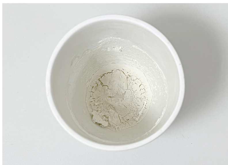
Рисунок 2 – Внешний вид наполнителя после отжига связующего полимерного материала в муфельной печи
