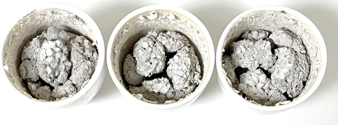
Рисунок 4 – Внешний вид наполнителя после отжига связующего полимерного материала в муфельной печи
